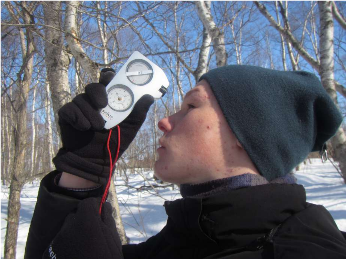
Рис. 5. Измерение высоты дерева
