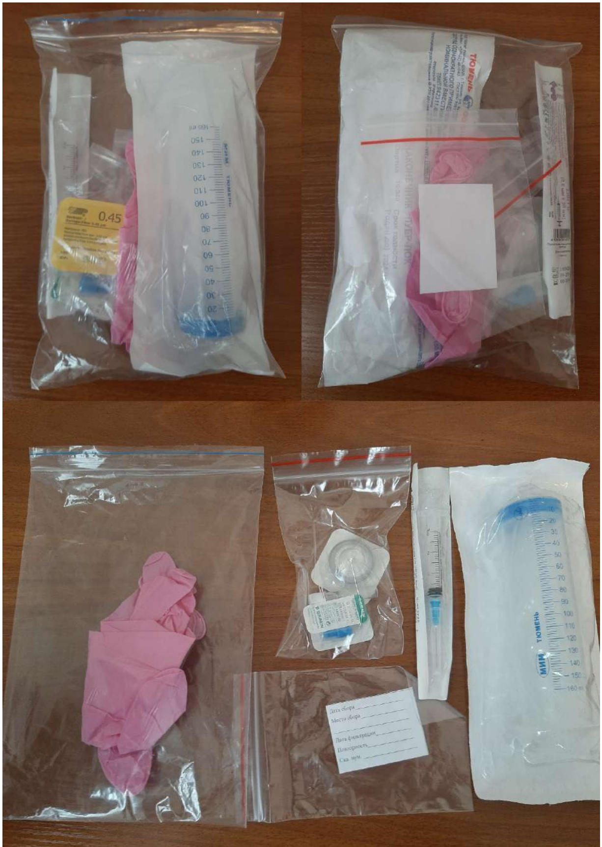
Рисунок 1. Набор и содержимое набора для фильтрации и фиксации ДНК из водной среды. Вверху – вид собранного набора, внизу – состав набора, детально.
